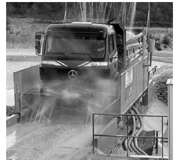
Une installation de lavage de pneus «Moby-Dick»-pour camions.
