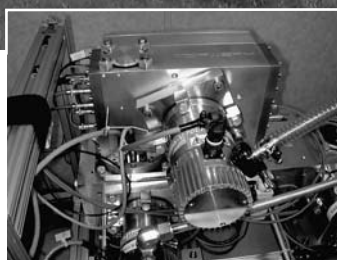
Spectromètre de masse à temps de vol (TOF)
