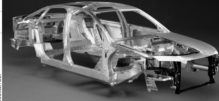
La carrosserie en aluminium de la nouvelle Audi A8.
