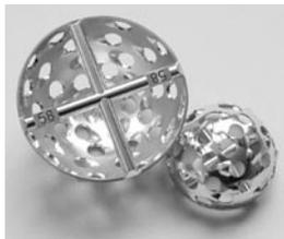
La fraise permet d'évider l'os de la hanche et de préparer la cavité où prendra place la tête du fémur. Le fond est ouvert pour permettre une meilleure vision de l'os.
