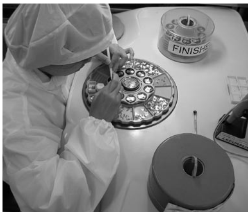
Une collaboratrice de la firme Ronda (succursale en Thaïlande) termine des mouvements de montres électroniques.
